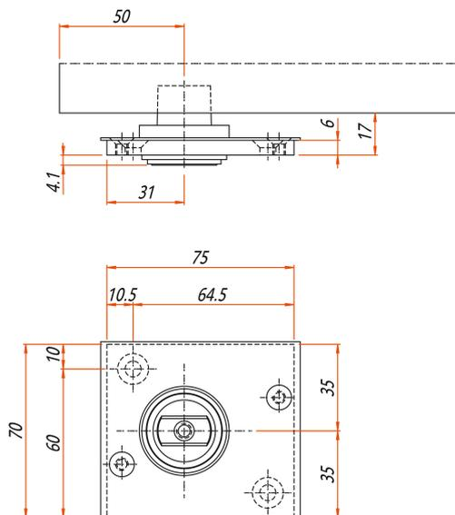
Exécution standard: aluminium oxydé pour épaisseur de verre 10 mm.
